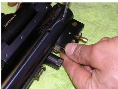
Si procede allo stesso modo sull'altro foro premendo o rilasciando il pulsantino della sicura finché non si trova la posizione. A questo punto, se si è inserito lo scatto armato bisogna ricordarsi di disarmarlo, altrimenti non è possibile caricare la carabina. Si posiziona quindi la leva di caricamento e si inserisce la spina avendo cura di allineare il foro e lubrificare con grasso.
