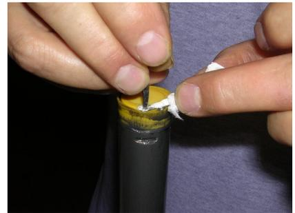
Quando si riterrà che azionando il pistone nel cilindro il grasso non verrà più trasportato in quantità eccessiva verso il fondo, si potrà procedere al montaggio definitivo. Io l'ho rismontata parecchie volte per togliere l'eccesso di grasso che un eccesso di zelo mi aveva fatto mettere.
