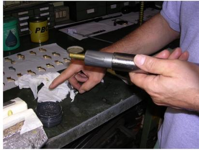
Si inserisce il pistone nel cilindro e lo si fa scorrere avanti e indietro parecchie volte, al fine di distribuire bene il grasso. Si sfilà di nuovo il pistone dal cilindro e si pulirà il fondo di quest'ultimo e la superficie anteriore della guarnizione dove sicuramente si sarà accumulato parecchio grasso.
