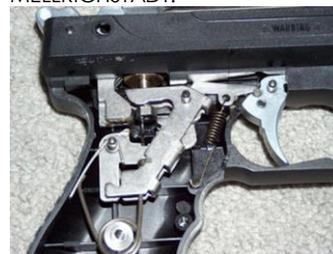
Si può udire in questa fase un piccolo sibilo provocato dall'aria che entra attraverso un foro presente nel cilindro principale della pompa. Il risucchio d'aria è causato dalla decompressione originatasi durante l'arretramento del pistone che scorre all'interno della pompa stessa. Simultaneamente viene anche udito un click causato dal precaricamento del grilletto ed inserimento della sicura automatica.
