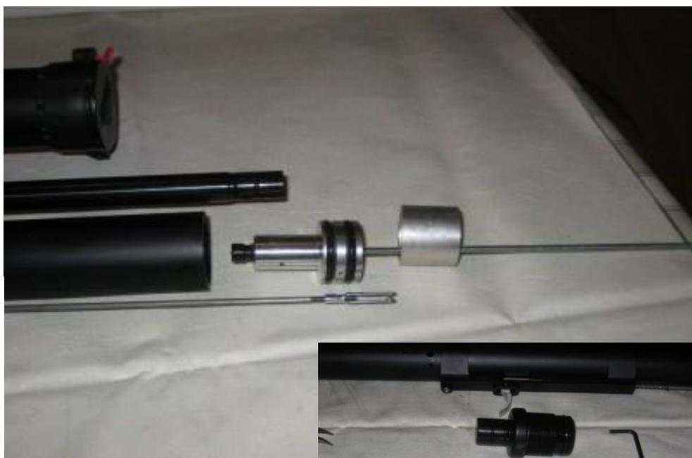
a questo punto apro una parentesi sul settaggio della valvola: quando andrete a rimontare le componenti della valvola, la ghiera forata va avvitata fino a quando non si appoggia sulla molla. dopo di che, basta solo dare ancora mezzo giro ad avvitare per avere il settaggio perfetto. fatto questo basta prendere una barra filettata m4 per avvitare nel foro del regolatore ed estrarlo.
